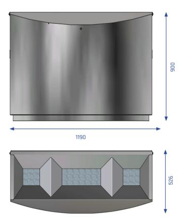
**Beschreibung:** Selbsttragende, gewölbte Front, ein flaches Rückteil und flache Seitenteile aus Edelstahl, befestigt mit einer Innen-Konstruktion aus verzinktem Stahlblech, sorgen für große Stabilität. Die trichterförmigen Einwurf-Öffnungen des Tops leiten eingeworfenen Abfall in die Innenbehälter und sind gleichzeitig elementarer Bestandteil des Brandschutzes (patentiert und zertifiziert).
