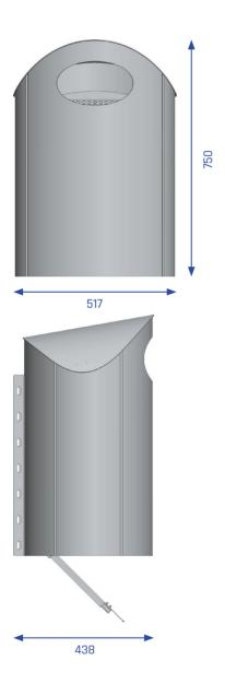
**Beschreibung:** Selbsttragender Korpus, mit gewölbten Seiten. Stabile Innenkonstruktion aus verzinktem Stahlblech, 1 oder 2-farbig, pulverbeschichtet. Gewölbtes Dach, fest mit dem Korpus verbunden. Durch ovale Einwurf-Öffnung auf der Frontseite reduzierter Einwurf. In die Einwurf-Öffnung integrierter Ascher, mit gelochter Ausdruckfläche aus Edelstahl. Separater Ascherschacht, vom Abfallraum getrennt. U-Profil an Korpus-Rückseite für universelle Befestigung an runden und eckigen Pfosten.
