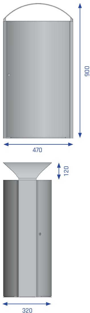
**Beschreibung:** Selbsttragende, gewölbte, pulverbeschichtete Stahlblech-Außenwände, mit stabilen flachen Seitenteilen verbunden. Extra verstärkte Tür mit verschweißten Scharnieren. 2 Tür-Rückhalteprofile verhindern Überdehnung. Verdoppelte Dachkonstruktion mit verschweißten Einwurfblechen, die den Abfall in den verzinkten Innenbehälter leiten. Innenbehälter oder Auffangwanne sind auslaufsicher abgedichtet.
