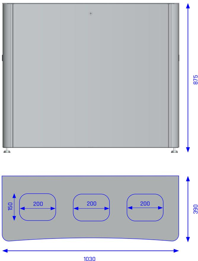
**Beschreibung:** Wand-stehende Ausführung aus nickelfreiem Edelstahl, mit nach innen gewölbter Frontpartie, flachem Top und gerader Rückseite (aus verzinktem Stahlblech). Empfohlener Einsatz im Innenbereich.
